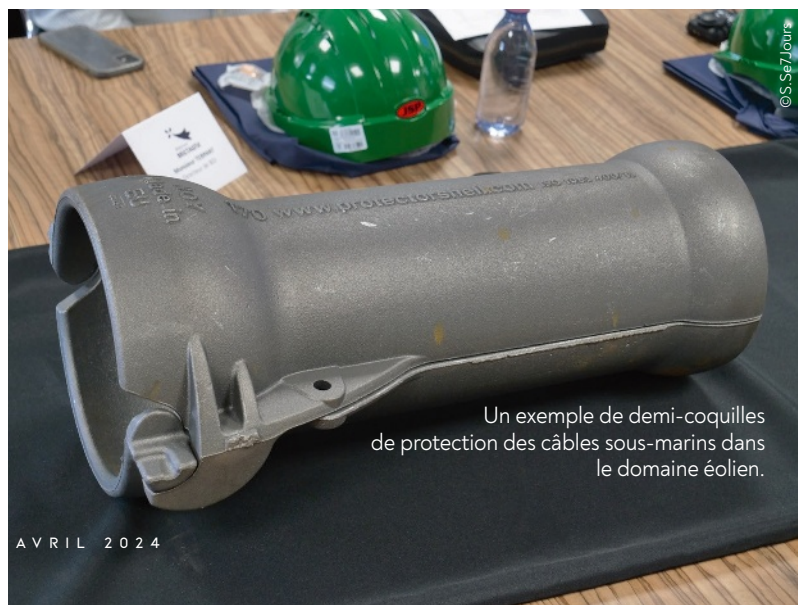
Les pièces sont fondues à plus de 1 500 degrés.
